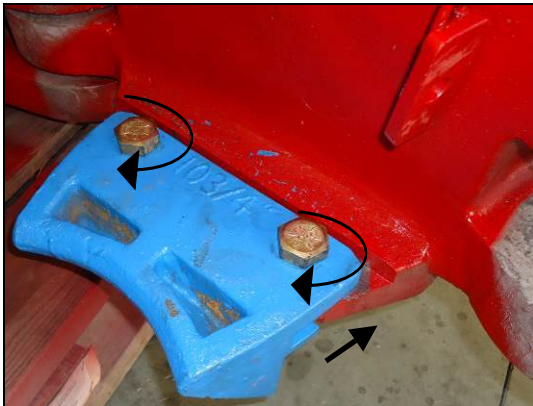
Door guide installation
